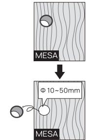
A furação do tampo deve ter entre 10 e 50mm de diâmetro e não deve ter nenhuma proteção plástica. A superfície deve ser plana e lisa. Prenda a base à mesa posicionando a parte inferior da braçadeira (A2) e o parafuso (A1) conforme a figura abaixo:
