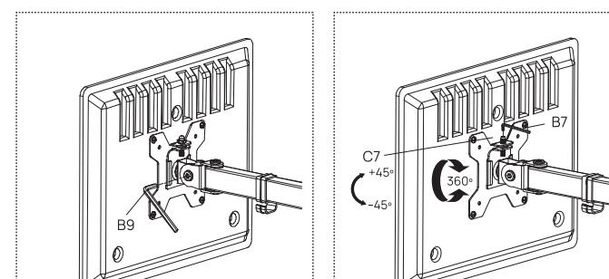
Ajuste o ângulo de inclinação desejado e aperte o parafuso com a chave Allen (B9) para travar.
