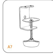
Fixe a braçadeira montada (A7) à base (B2) com a haste, com os 2 parafusos (B5). A braçadeira vai por baixo da base. Pronto, agora é só fixar à mesa.
