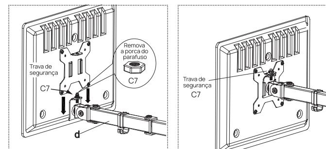
Remova a porca da trava de segurança (C7). Em seguida encaixe a placa VESA à extremidade do braço, conforme o desenho acima.
