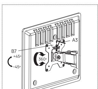
Se um monitor estiver mais baixo, remova a porca da trava de segurança (B7) e gire o parafuso no sentido anti-horário usando a chave Allen (A3), para levantá-lo. Aperte bem a porca após ajustado.
