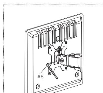
Ajuste o ângulo de inclinação desejado e aperte o parafuso com a chave Allen (A6) para travar.
